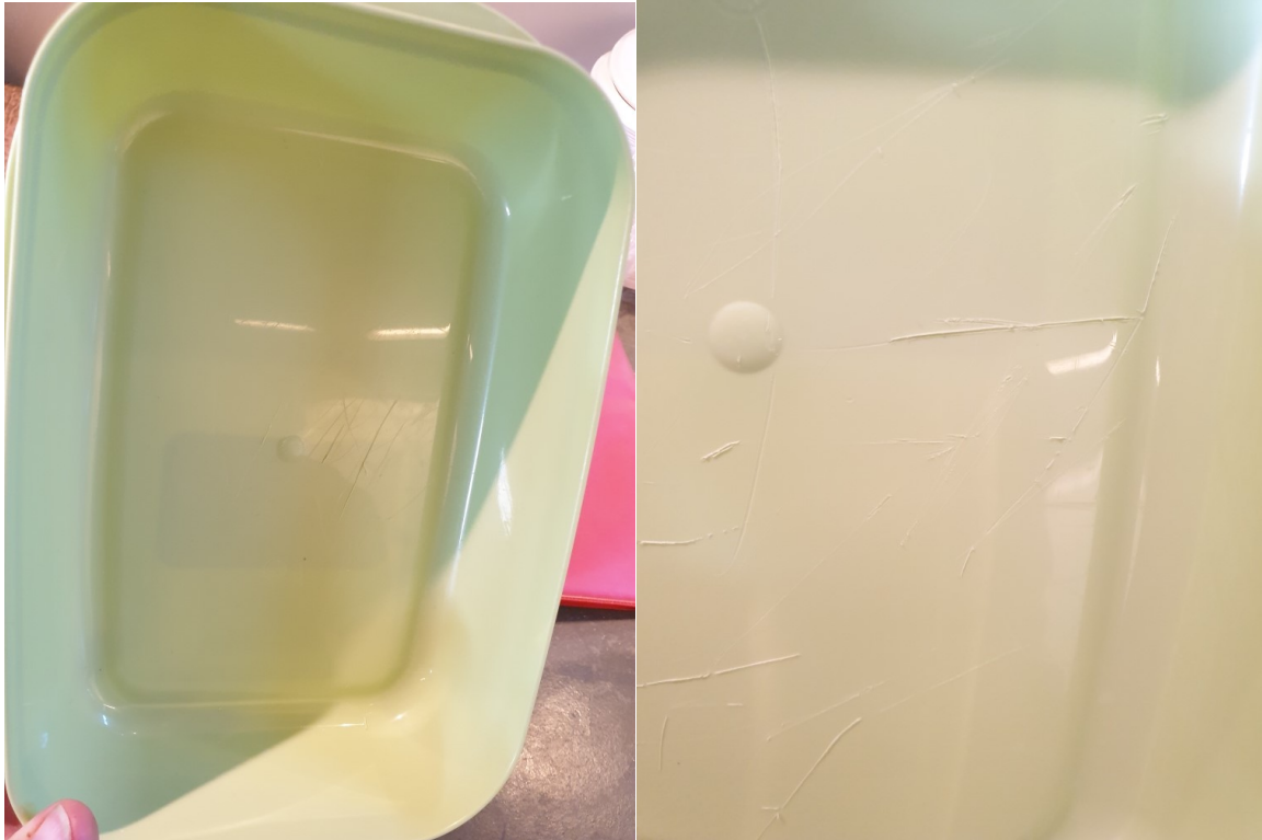
Figur 17. Bilder tillhandahållna av Ulls Restaurang på flergångsmatlåda i plast som skadats i botten av bestick.
